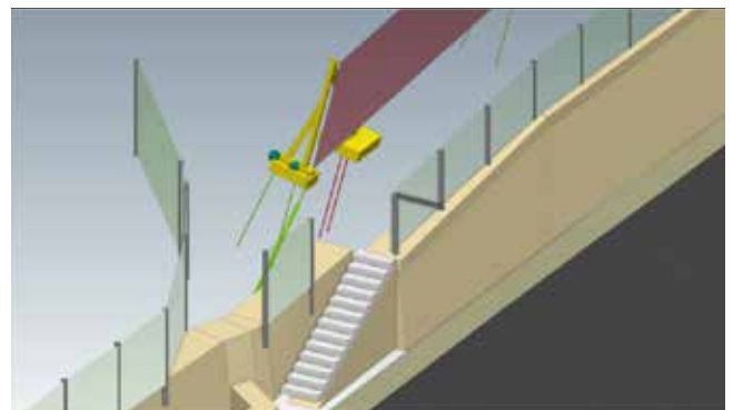
Abb. 9: Farbliche Kennzeichnung des Bautenstands (grün – Mikropfähle hergestellt; rot – Mikropfähle noch nicht hergestellt)
