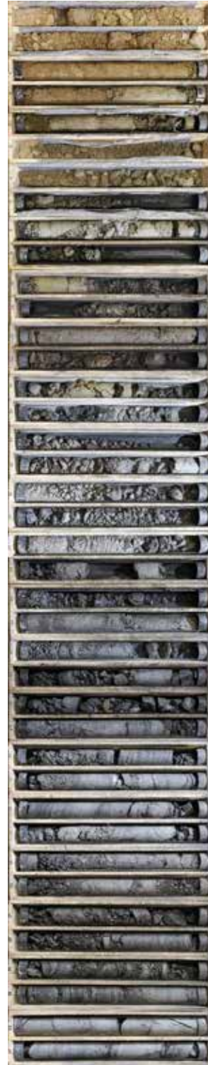
Abb. 4: Fotoaufnahme der Kernbohrung 2: Die Lockergesteinsauflage („Schicht 1“) ist an ihrer Braunfärbung zu erkennen. Darunter folgen die Rutschmasse mit kataklas- tischen Zonen („Schicht 2“) sowie devonische Sand- bis Tonsteine („Schicht 3“) (Foto: A. Wehinger).
