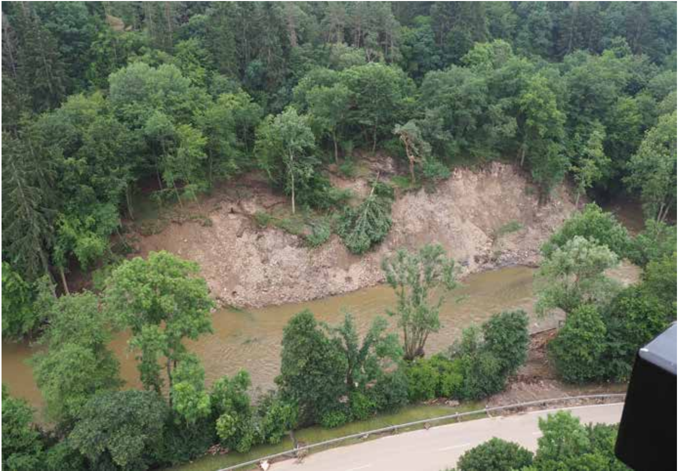
Abb. 1: Luftaufnahme vom 17.07.2021 mit Ansicht des infolge des Hochwassers erodierten Ahrufers der Rutschung südöstlich der Ortslage Müsch (Foto: A. Wehinger).
