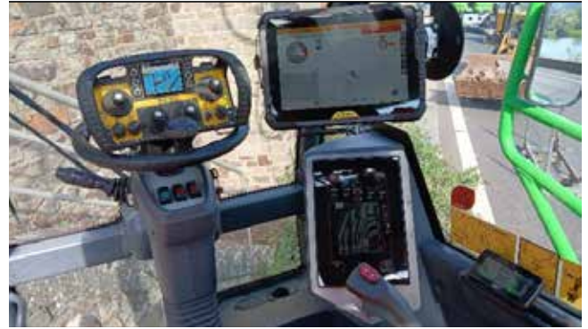
Abb. 8: Koordinatengetreues Ansteuern der Bohransatzpunkte mittels einer GPS-gestützten Bohrlafette
