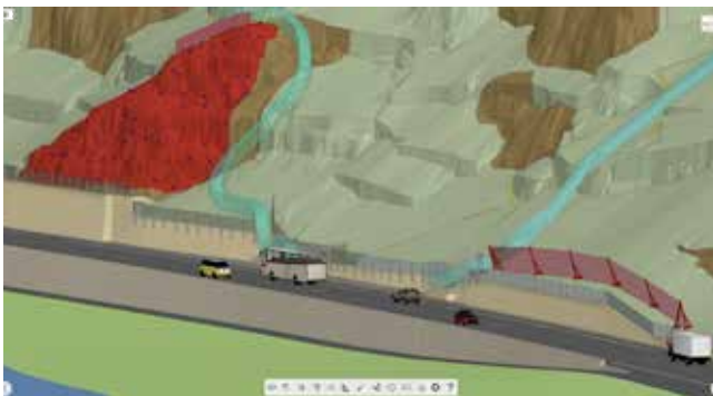
Abb. 7: Geotechnisches-Bauwerk-Modell (GBM) in der CDE-Umgebung
